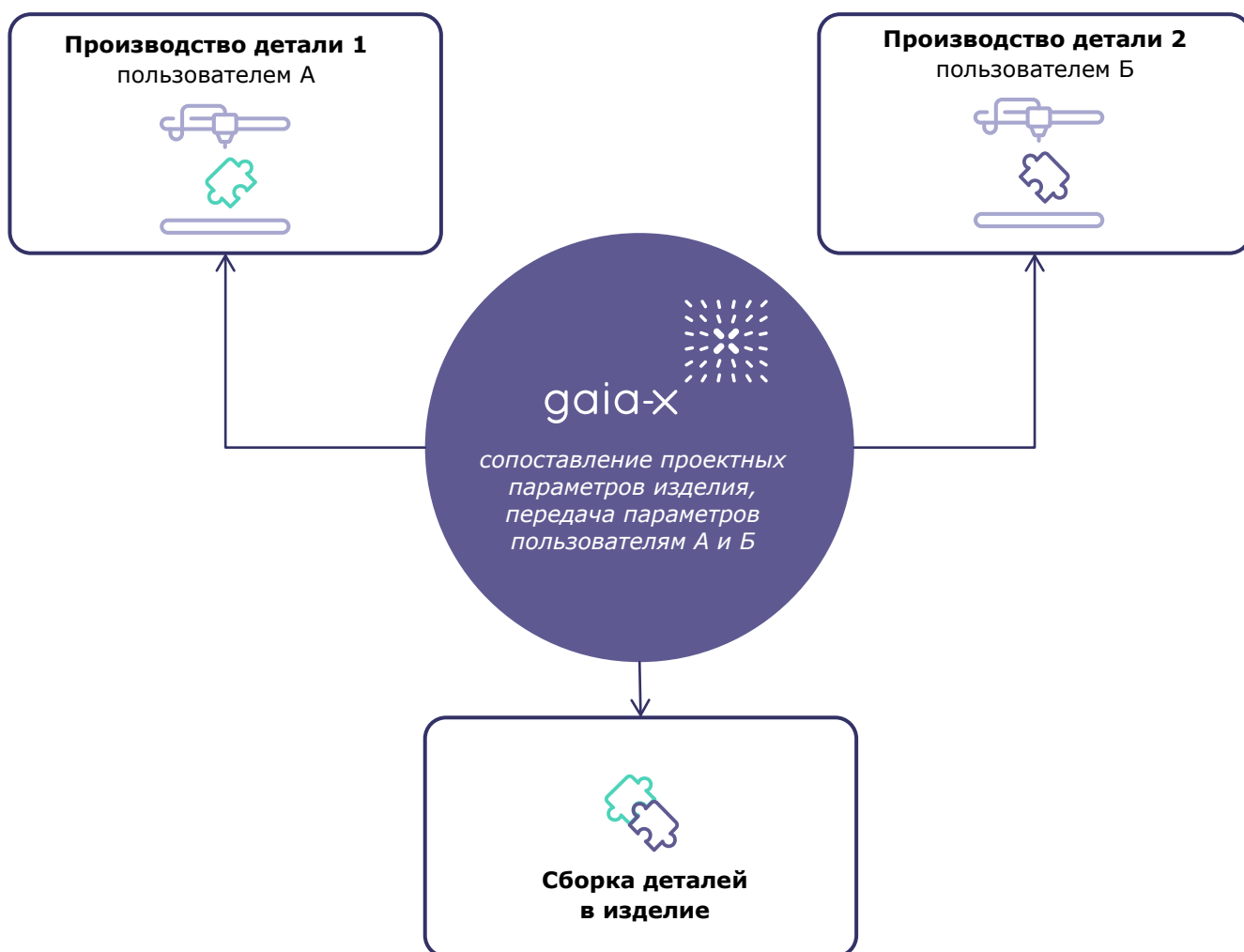
Рисунок 10. Принцип работы GAIA-X при производстве деталей различными производителями
